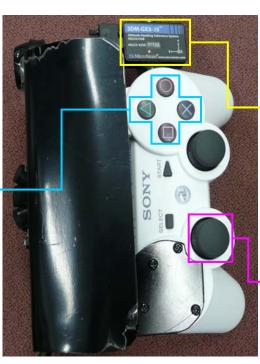
3Dセンサー スプレーデバイスの傾き を検出します。
