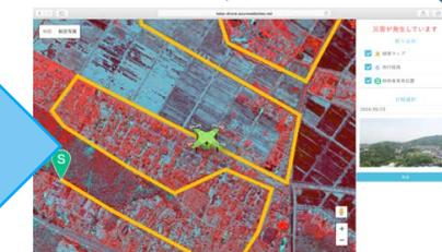
映像、飛行ログから被害状況、被害マップを生成します。
