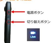
Theta S の切り替えボタンを長押ししながら電源ボタンを押し, ライブ配信モードで起動して下さい。カメラの正面に青色の LIVE マークが点灯します。
