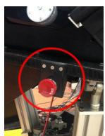
シンクロアスリートには「非常 停止スイッチ」が 2 カ所用意され ています。どちらかの非常停止ス イッチを押すことでモーションシ ミュレータを強制的に停止します。 安全のため、シンクロアスリート を利用する時は緊急時に非常停止 スイッチを押せる人が必ず押せる 位置にいてください。
