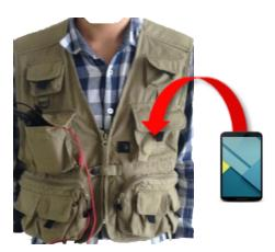
初期化・送信開始ボタンをタップして,10 秒以内にデータ記録用スマートフォンを縦にして,画面をつけたまま液晶面が体の外側を向くように,ポケットの中に入れて下さい。ポケットに入れる時,スマートフォンの上下表裏を逆にしないよう注意して下さい。
