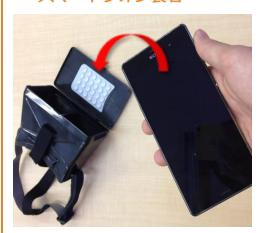
ヘッドマウント用スマートフォンをヘ ッドマウントディスプレイケースに取 り付け,装着して下さい。
