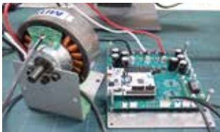
写真1 200WクラスのDCブラシレス・モータとモータ・ドライバ・ボード
