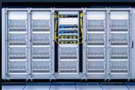
独自開発の深層学習用プロセッサMN-Core™を搭載したスーパーコンピュータMN-3が、省電力性能ランキングGreen500で世界1位を獲得（2020年、2021年）
