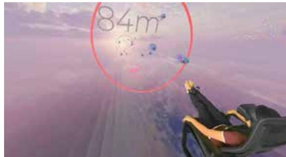
Chair Absは空飛ぶ椅子に座り隕石を避けながら飛行することで、主に腹筋と前腿を鍛えることができる。VR内に現実の脚を連動させる仕組みは、足先のコントローラーの座標からプレイヤーの脚長を測定し、同時に膝位置も測定する。脚長と脚を曲げた長さとの差を膝のY座標に足すことで膝の動きを現実と一致させた。実際に椅子に座り、足先にコントローラーを付け脚を上下左右に移動させることで椅子を自由に操縦でき、自分の脚と連動する仮想の脚があることで、操縦しやすくなっている。
